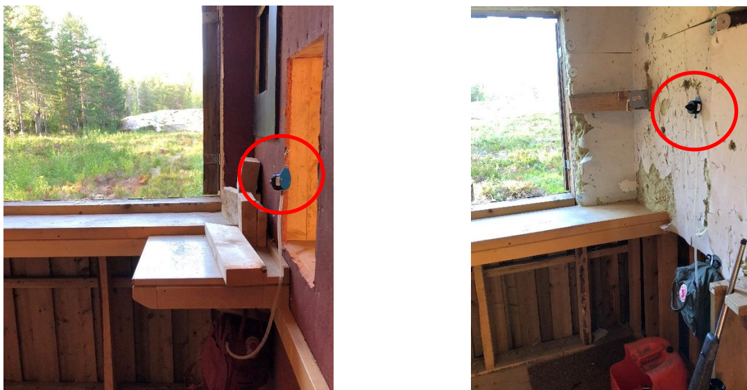
Figur 1a+b. Vänster och höger skjutbås för älgbanan. Pumpad provtagare för damm i huvudhöjd på höger sida om stående skytt. Skyttet sker ut genom den större öppningen mot skjutvallen
